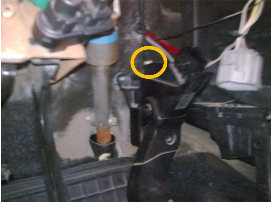
Bien ya tenemos lo más "difícil", ahora vamos a colocar nuestro módulo en un sitio cómodo. Como podréis ver en las fotos, hay un orificio justo encima del acelerador, bien, el cable debería venir por ahí y luego el módulo instalado en el habitáculo del motor.
