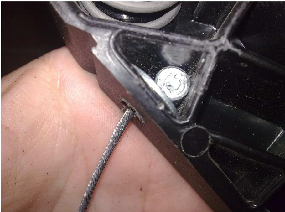
Lo siguiente hacer otro agujero en la parte posterior para poder meter el cable del servo del control de velocidad. Mucho ojo con no hacer el orificio demasiado ancho para que nos sirva de tope y podamos ejercer presión.
