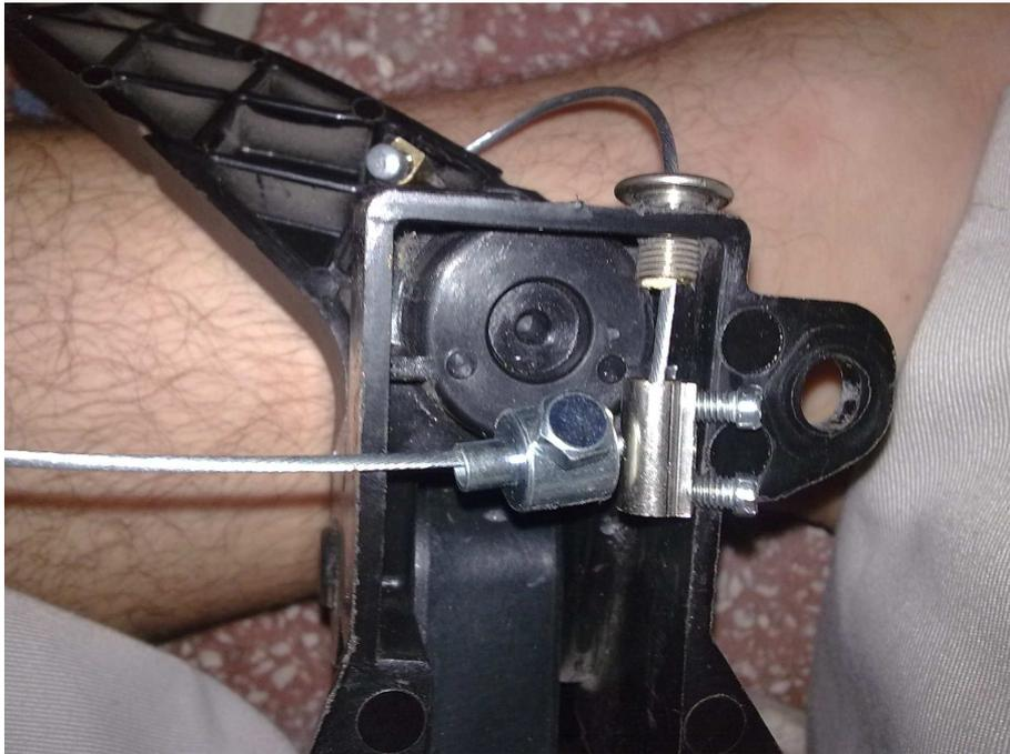
Por el pedal ponemos la parte del cable de acero que tiene la cabeza de forma que nos haga de tope y no se nos salga.
